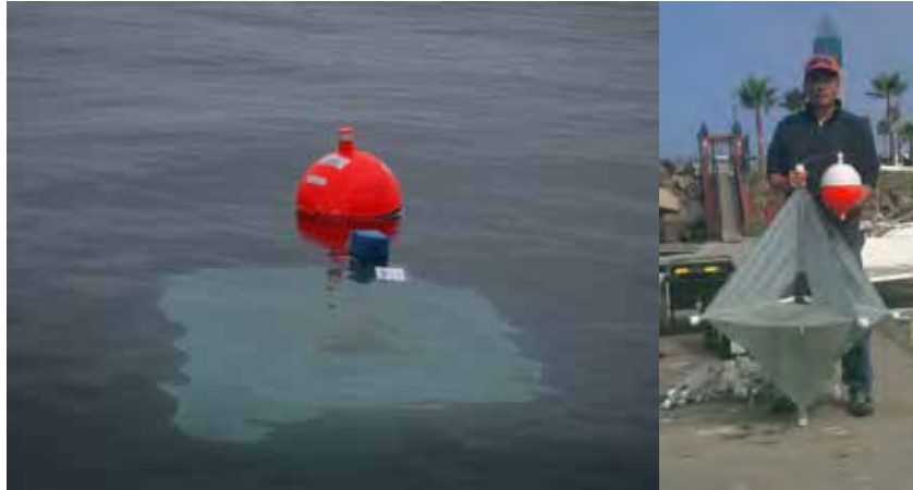
Figura 3. Boyas de deriva utilizada para los experimentos en la BTS durante el periodo de 2012. El lado izquierdo de la figura muestra una boya Microstar en el agua en su posición encendida, de la que pende un papalote colocado a 1.5 m de profundidad, mientras que del lado derecho se muestra el papalote y la boya fuera del agua en su posición apagada (invertida).
